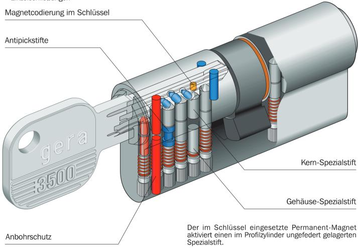
Für dieses Produkt ist der Standard-Schlüsselrohling **GERA 3500**-magnetcodiert verwendbar.
